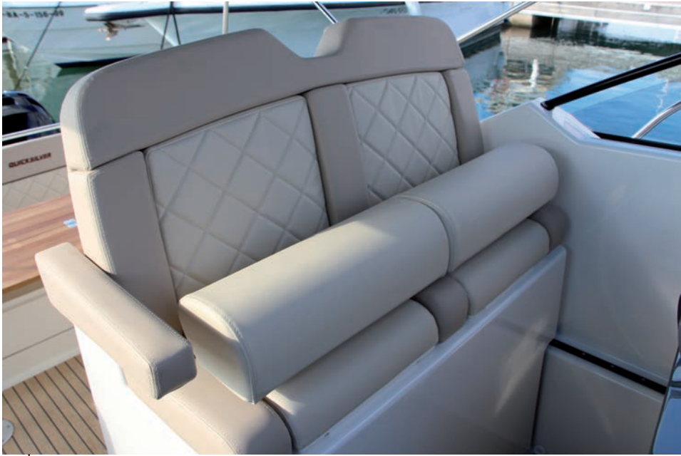
El asiento doble del piloto es una estructura corredera.
