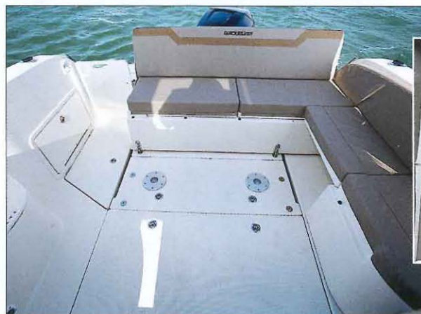
Le plancher du cockpit abrite des grands coffres dont une soute très profonde. Les capots sont assistés par de solides vérins.
