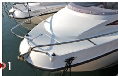
1. En la 505 la cubierta queda elevada para ganar volumen en la cabina.
