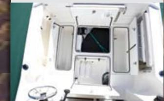
El suelo de la bañera se abre por completo en cuatro amplios cofres, uno de ellos, con cierre, para guardar las cañas.
